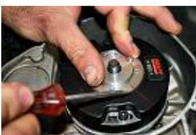
Svitare il blocca pistone e utilizzarlo come astina per posizionare il pistone al punto morto superiore. al punto morto superiore far coincidere i due segni rossi dello statore e del rotore premium. stringere il rotore con il dado originale. Il segno rosso esatto è quello con la freccia corrispondente al senso di rotazione del motore.
