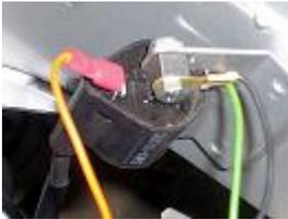
Togliere il cavo arancione della bobina ad alta tensione per sostituirlo con il cavo arancione della centralina premium. togliere la vite di fissaggio della bobina e rifissarla conservando il cavo nero originale più il cavo nero della centralina premium e il cavo verde/giallo dello statore.
