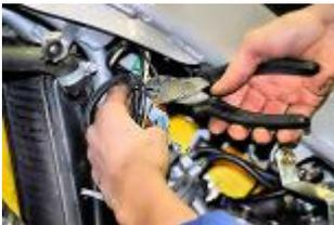
Tagliare le fascette in plastica che fissano il cablaggio fino alla bobina.
