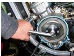
Svitare il dado da 15 mm del volano con una chiave a pipa da 15 mm.
