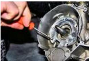
Posizionare la staffa premium e avvitare con le tre viti fornite con un cacciavite a croce.
